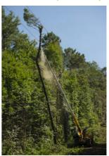
Avec ses partenaires, Enedis utilise l'une de ces trois techniques en fonction des règles techniques de sécurité et d'accessibilité. La JARAFF est un engin doté d'une scie circulaire placée à l'extrémité d'un mât télescopique pouvant atteindre une hauteur de 22 mètres. Cette méthode est cinq fois plus rapide que les techniques classiques. Elle permet d'élaguer environ 1 km de ligne par jour.
